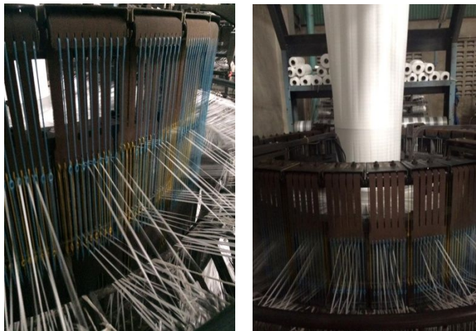
รูปที่ 6 เครื่องทอกระสอบที่ทำสีเสร็จและเริ่มทำงาน
