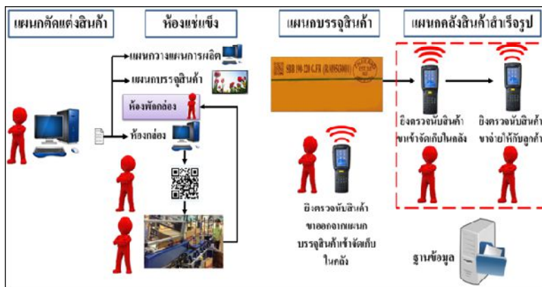
รูปที่ 5 ระบบการตรวจนับสินค้าด้วยอุปกรณ์คอมพิวเตอร์พกพา
